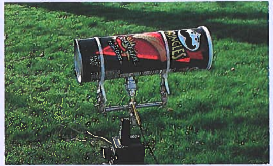
▲ Foto 13 Deze foto willen we u als toetje bij dit artikel niet onthouden... Bouw zelf je antenne, want je hoeft geen veelverdiener te zijn om met WiFi aan de slag te gaan.
